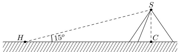
Il pose ses instruments de mesure (*le théodolite*) au point  $H$ . En étudiant la pyramide, il observe que c'est une pyramide régulière : le pied  $C$  de la hauteur issue du sommet  $S$  est également le centre de la base. Il estime également la distance  $HC$  à 550 m.
